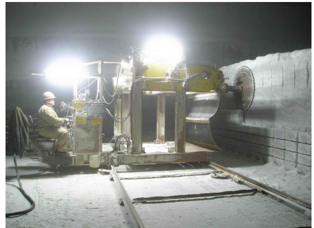
Die Salzblöcke werden herausgeschnitten.
